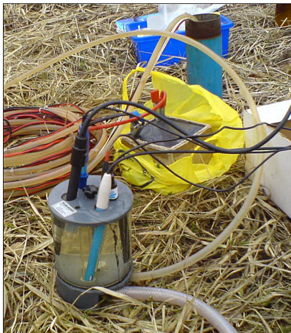
Rys. 2. Pomiar parametrów fizykochemicznych z użyciem komory przepływowej (Fot. D. Porowska) Fig. 2. Measurement of physicochemical parameters using the flow-through cell
